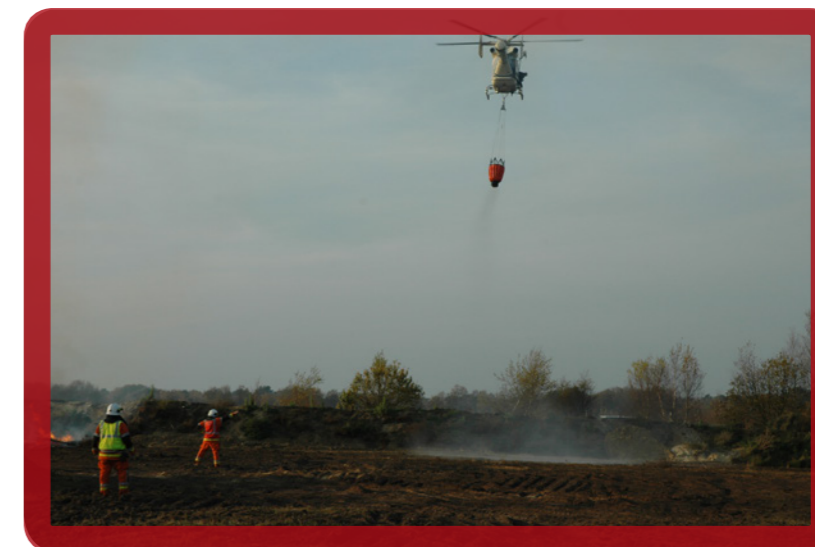
Een helikopter van de politie waaraan een reservoir met bluswater bevestigd is. Daarmee kan een brand vanuit de lucht bestreden worden, onder begeleiding van brandweerteams op de grond.
